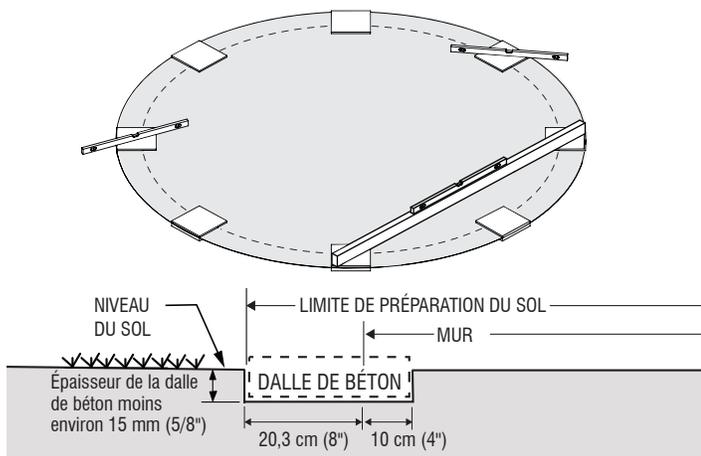
**Option poussière de roche :** Ajoutez la poussière de roche\* nécessaire pour recouvrir la section de 30 centimètres (12 pouces) de large entre les lignes en pointillés (zone d'enlèvement de gazon). Compactez soigneusement la poussière de roche\* à l'aide d'un outil de compactage ou d'une plaque vibrante (voir l'illustration 2.1). La zone de poussière de roche doit être parfaitement nivelée en utilisant un outil de nivellement approprié.
