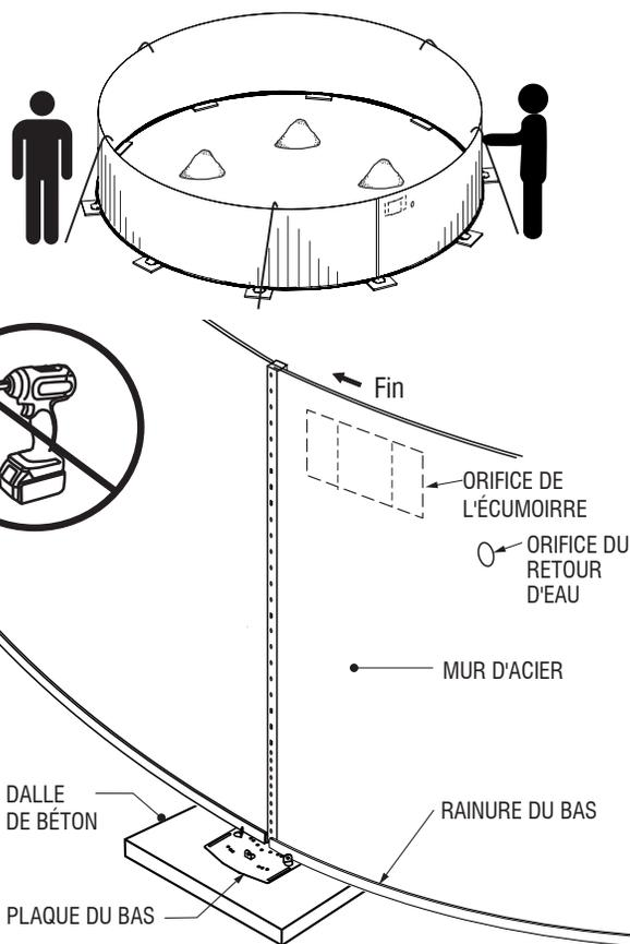
Insérez les boulons et les écrous (BB) dans chaque trou et serrez-les avec une clé (la tête de vis du côté intérieur de la piscine). Recouvrez les têtes de vis de 3 couches de ruban adhésif toilé. **Vous devez utiliser les boulons et les écrous de mur fournis dans la boîte du mur.**
