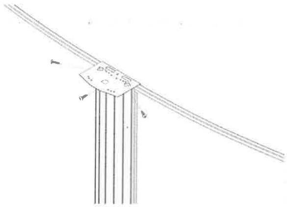
Déposez la plaque du haut sur les montants verticaux. Posez les vis à métal au haut du montant vertical en vous assurant que les montants soient perpendiculaires à la surface du sol.
