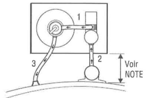
Insérez des embouts filetés, s'il y a lieu, de façon à pouvoir fixer la valve dans l'écumoire.
