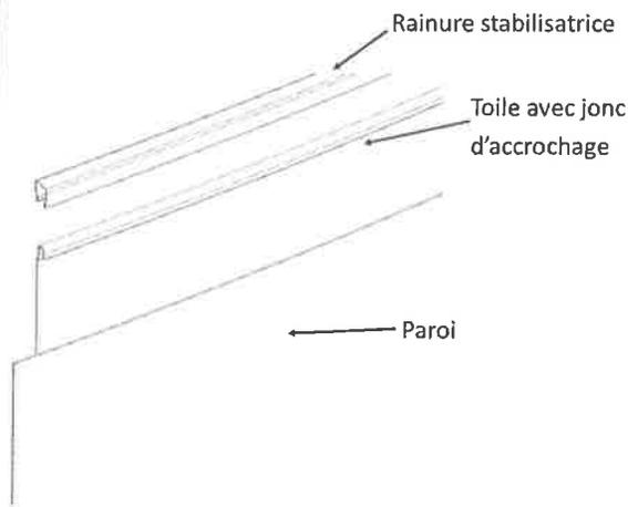
Accrochez la toile "u-bead" sur le sommet du mur et installez la rainure stabilisatrice par dessus la toile.
