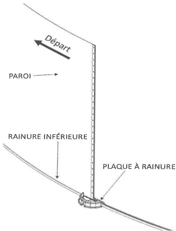
Insérez la paroi dans la rainure inférieure en commençant au centre d'une plaque. Au départ, une ou deux barres de soutien maintiennent la paroi en place. Une personne déroule la paroi sur un madrier ou une planche, tandis qu'une autre personne l'insère dans la rainure inférieure. On ne doit pas dérouler plus de 3 m (10') sans mettre en place une barre de soutien pour renforcer la structure.
