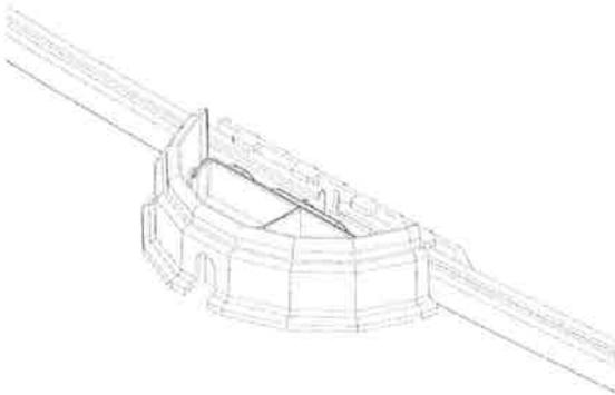
Assemblez toutes les rainures inférieures aux plaques à rainure de façon à former un cercle parfait avec un diamètre et un rayon conforme au tableau.
