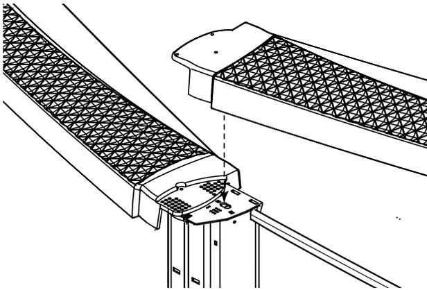
Placez les sièges sur les parties supérieures des poteaux en vous assurant que la tige sous le siège soit bien insérée dans les trous oblongs de la plaque. Déposez tous les sièges sur les poteaux avant de les fixer.
