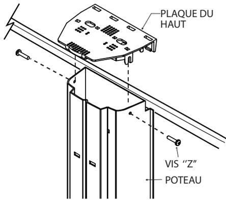
Déposez les plaques du haut sur les poteaux et maintenez-les en place à l'aide de deux (2) vis "Z" de chaque côté.
