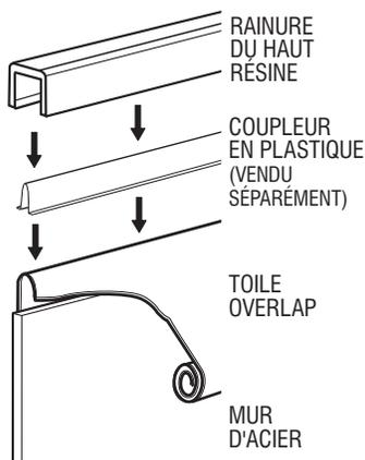
Détail de l'installation de la toile avec jonc d'accrochage. Accrochez la toile sur le sommet du mur et installez la rainure du haut par dessus la toile.
